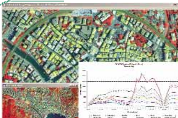
Гиперспектральная съемка камерой CASI-1500 (использовано 36 спектральных каналов, пространственное разрешение 50 см)
